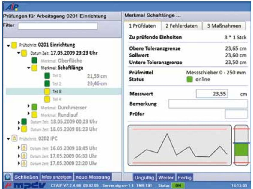
Auch die Prüfdatenerfassung im Rahmen der Werker selbstprüfung kann jetzt auf Basis des ergonomischen AIP genutzt werden.
